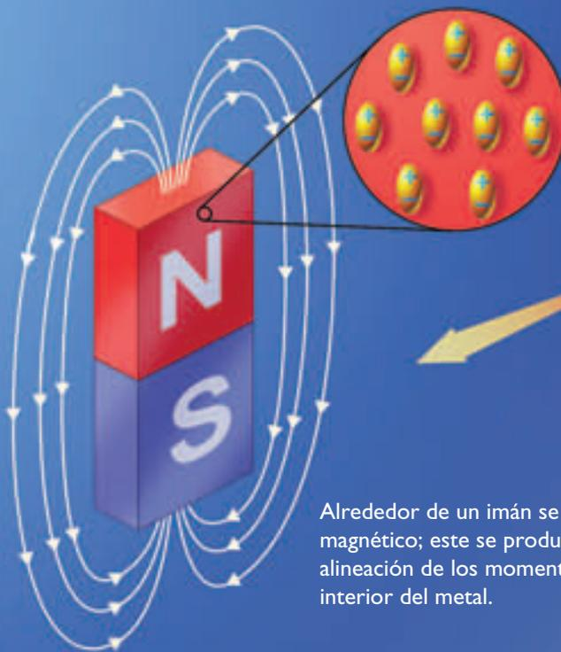
Alrededor de un imán se genera un campo magnético; este se produce debido a la alineación de los momentos dipolares al interior del metal.
