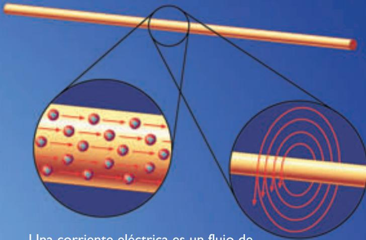
Una corriente eléctrica es un flujo de cargas a través de un conductor.
